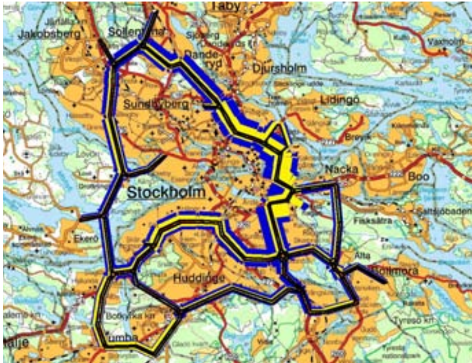
Figur 17. Vagnflöden (blå), varav tomvagnar (gul). Största flöde är 3450 vagnar/timme och riktning. Källa: Ingmar Andreasson, LogistikCentrum.
