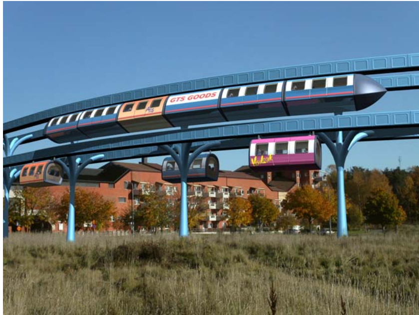
Figur 20. I förvrörterna kan man köra GTS-högfartsfordon i ett plan ovanför- och GTS-lågfarts-"spårtaxi" inunder (Kylberg).
