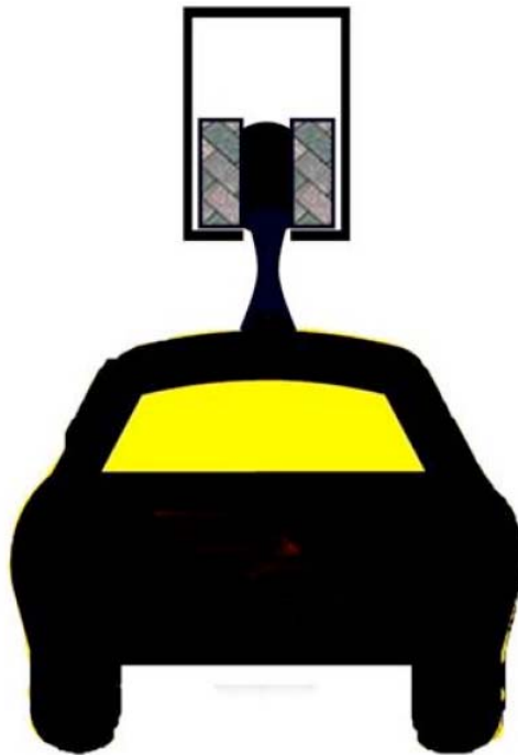
Figur 10. GTS-fordon hängande under balk med drivning i balken
