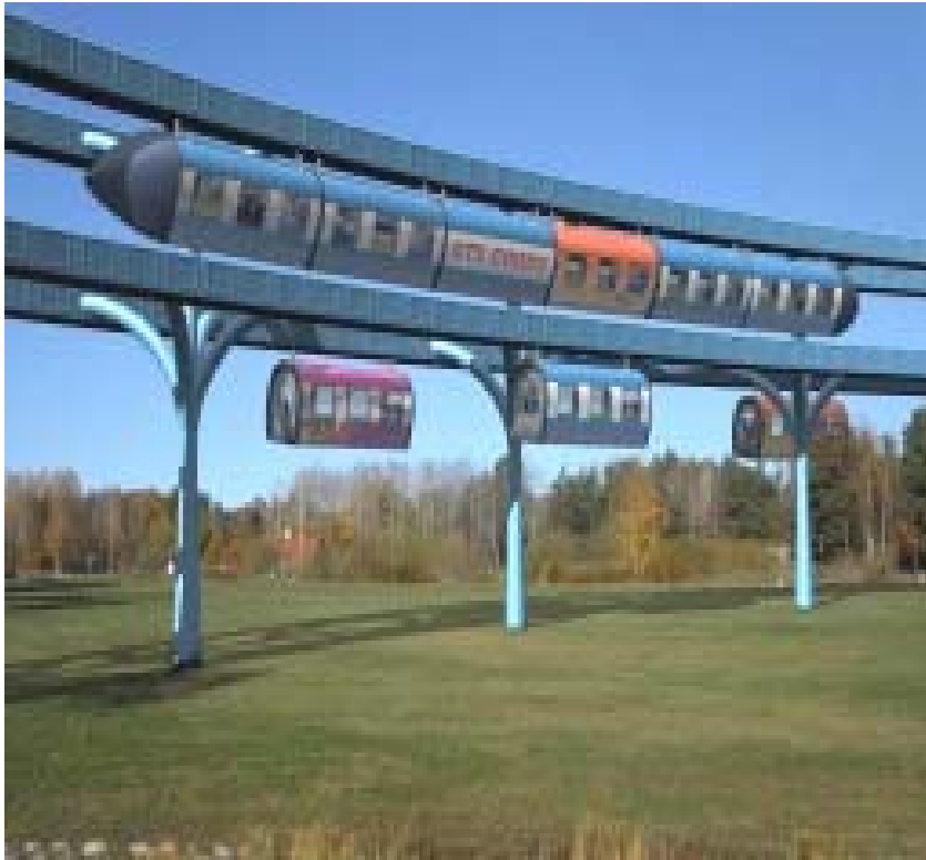
Figur 19. En bana med hög hastighet i lantlig omgivning med GTS-högfartsfordon i ett plan ovanför- och GTS-lågfarts-”spårtaxi” inunder (Kylberg)
