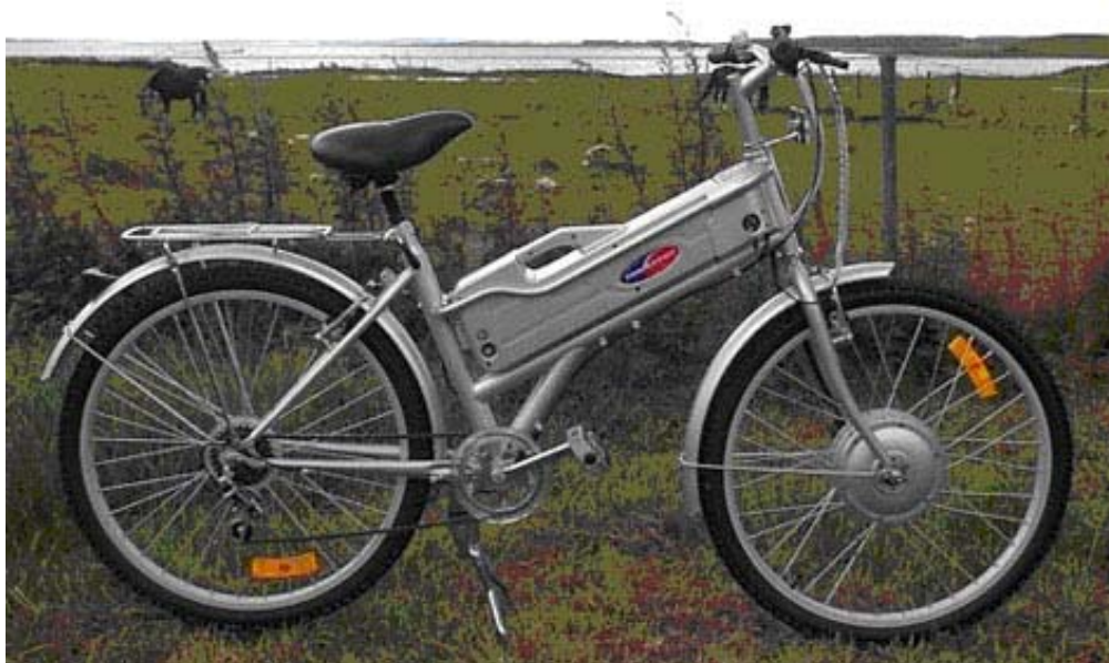
Elassisterad cykel, den cirkulära motorn i framhjulet ger 200 W.
